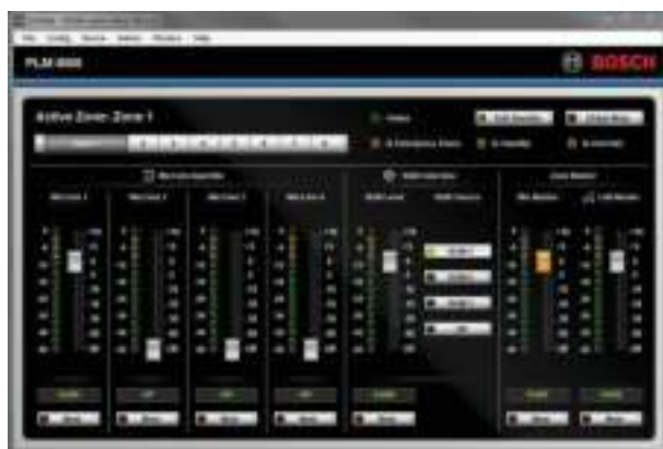
Рисунок 7.1: Главный экран графического интерфейса матричного микшера DSP
