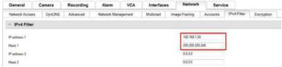
При использовании функции **IPv4-фильтр** устройства могут сканироваться с помощью RCP+, но доступ к параметрам конфигурации и видео невозможен через клиентов, которые находятся вне диапазона разрешенных IP-адресов. Это включает доступ через веб-браузер.
