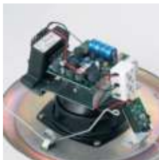
LC1-PIB, установленный на громкоговоритель и отображающий световод
