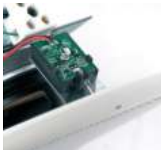
LC1-PIB, установленный на громкоговоритель и отображающий световод
