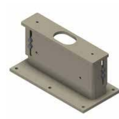
MOUNTING CONSOLE - монтажная консоль для установки на неготовый пол
