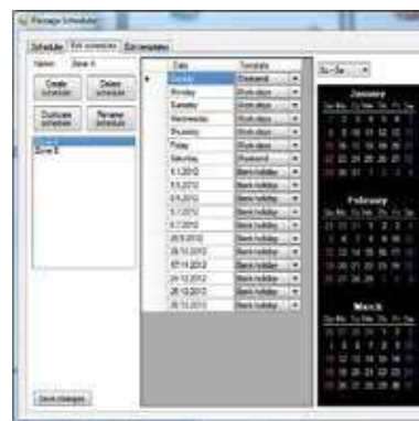
PASSAGE SCHEDULER - программное обеспечение для автоматического программирования режимов работы турникета
