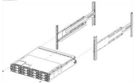
6. Закрепите устройство на задней панели салазок, вставив два винта М5 в кронштейны на блоке и кронштейн на рейке.
