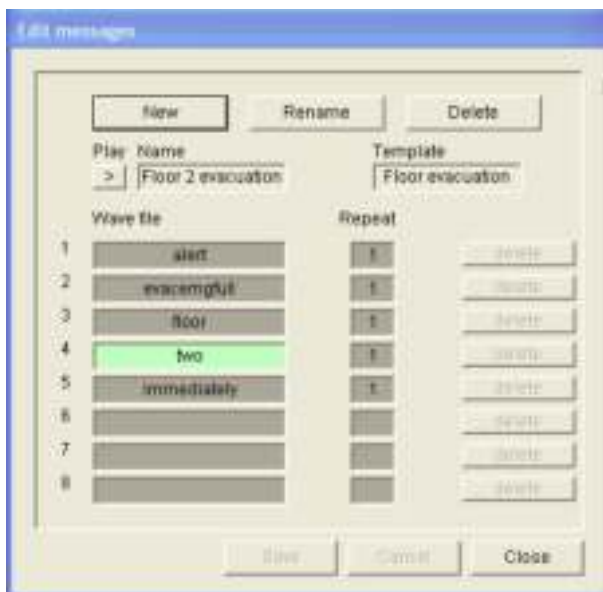
Рисунок 4.26: Пример: эвакуация этажа 2
