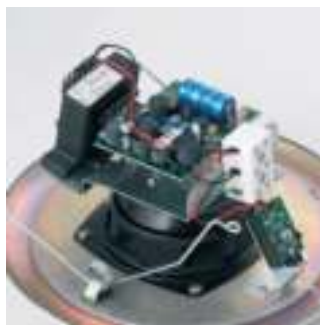
LC1-PIB, установленный на громкоговоритель и отображающий световод
