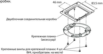
**[Тип 3]** Установите камеру на потолок или стену с помощью кронштейна для основания (аксессуар) **X4571L S4550L**
