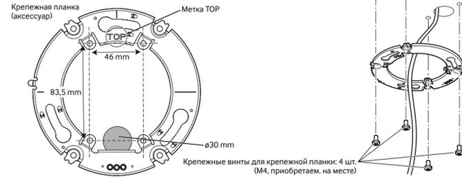
**<Подготовка отверстия доступа параллельного кабеля X4571LM S4550LM>**
