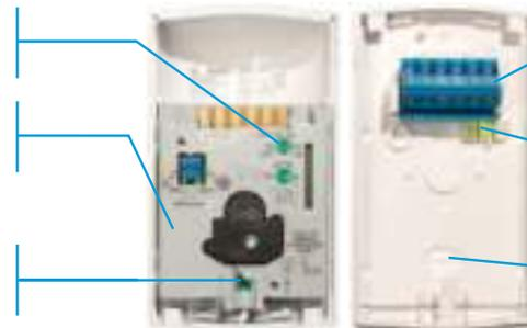
Съемные зажимные контактные колодки с подъемной крышкой исключают ошибки подключения
