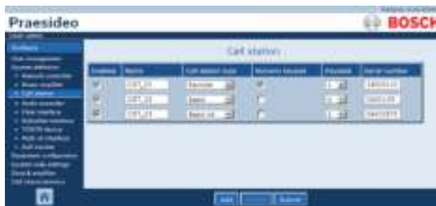
рисунок 43.13: Описание вызывной станции
