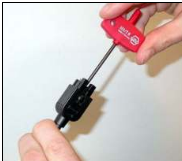
рисунок 30.36: Затягивание винта с внутренней звездочкой
