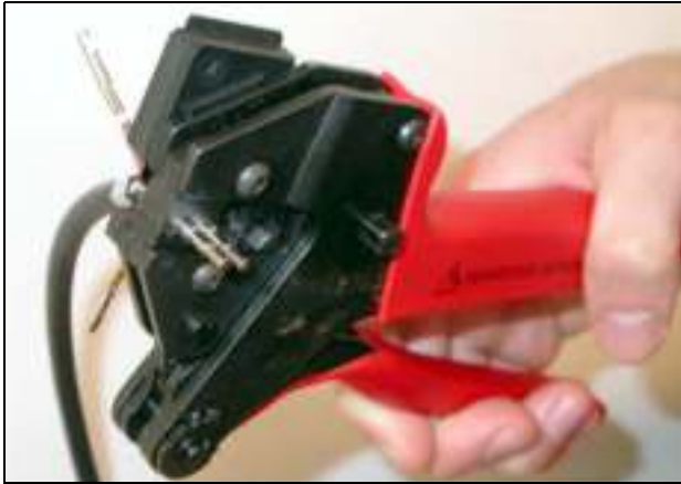
рисунок 30.24: Обжимка металлических наконечников (3)
