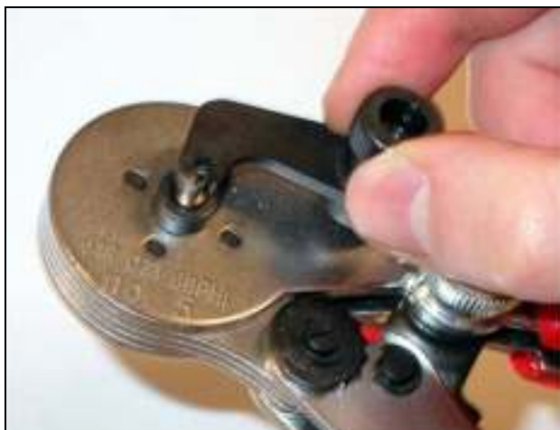
рисунок 30.21: Фиксация металлического наконечника
