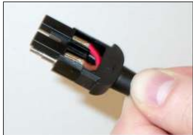
рисунок 30.33: Монтажный блок/задняя часть корпуса в сборе
