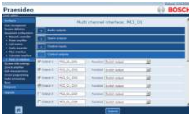
рисунок 44.26: Выходы управляющего сигнала для многоканального интерфейса
