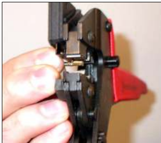
рисунок 30.11: Обжимка гнездового контакта (1)
