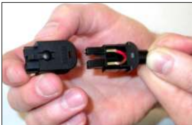
рисунок 30.34: Установка передней части корпуса
