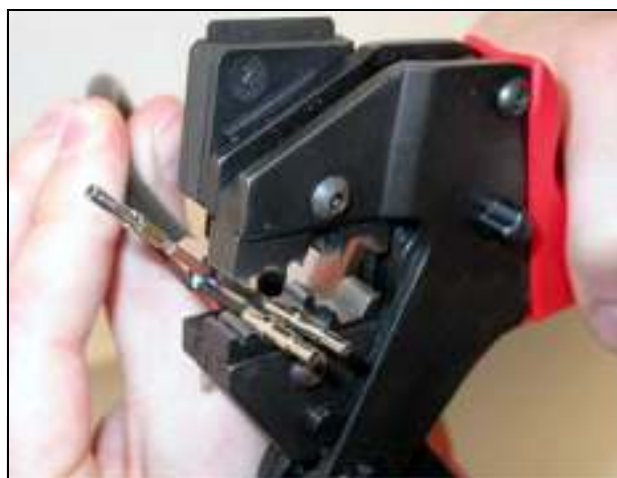
рисунок 30.23: Обжимка металлических наконечников (2)
