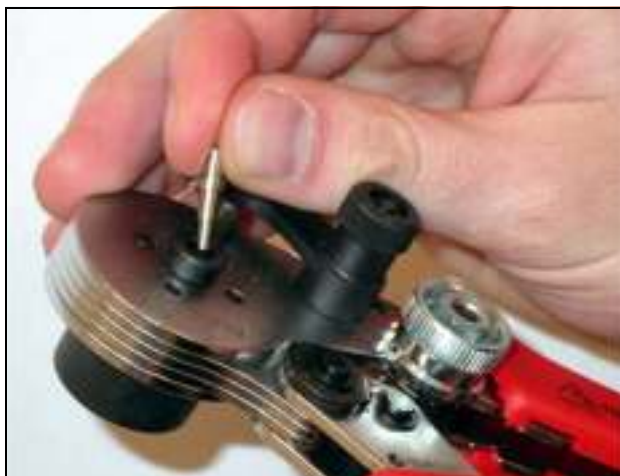
рисунок 30.20: Вставка металлического наконечника
