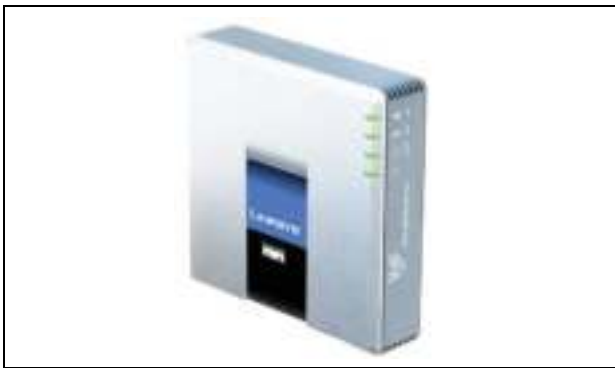
рисунок 63.1: Голосовой шлюз с маршрутизатором Linksys SPA3102
