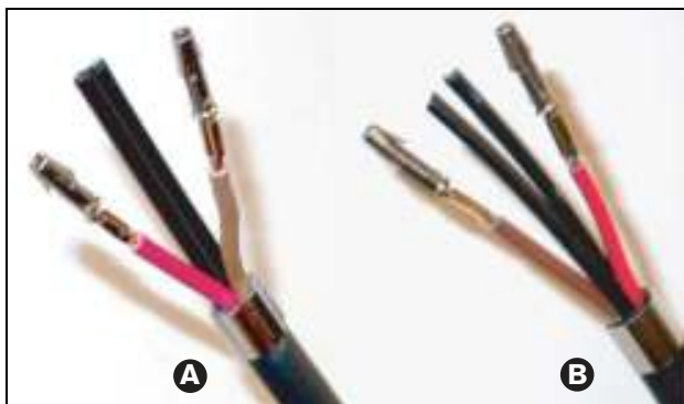
рисунок 30.14: Установленные гнездовые контакты
