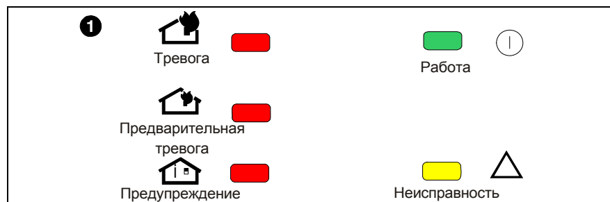
Рис. 2.5: Индикация TITANUS® (пояснения см. № 1 в таблице на следующей странице)
