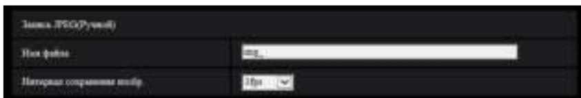
Данная настройка доступна только тогда, когда выбран параметр “JPEG(1)”, “JPEG(2)” или “JPEG(3)” для параметра “Формат записи”, а для параметра “Сохранить триггер” выбрана опция “Ручной”.
