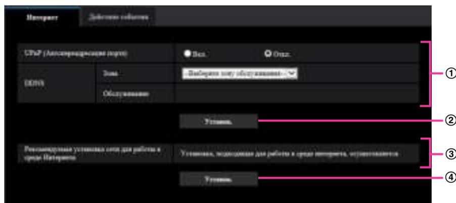
По окончании задания параметров в поле ① щелкают по кнопке [Установ.] (②) под полем (①). Редактированные уставки в поле ① не применяются, если не производится щелчок по кнопке [Установ.] (②) под полем (①). Аналогичным образом щелкают по кнопке [Установ.] (④) под полем ③ по окончании задания параметров в поле ③.
