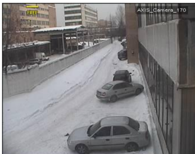
Рисунок 12.8 – Индикатор состояния канала управления видеокамеры «FREE»
