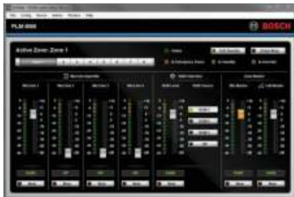
Рисунок 7.1: Главный экран графического интерфейса матричного микшера DSP
