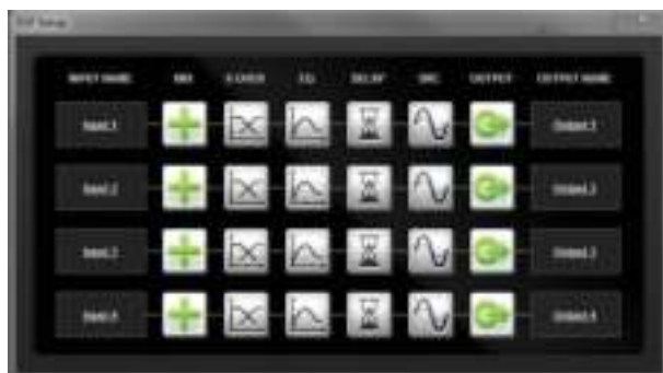
Рисунок 7.4: Экран настроек графического интерфейса усилителя DSP
