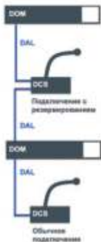
Варианты подключения микрофонных консолей
