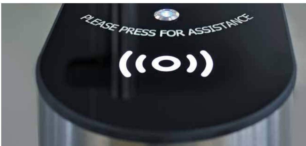
Встроенная кнопка экстренного вызова с подсветкой
