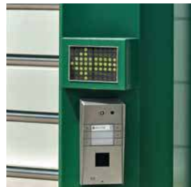
LANE LIGHT – световая панель индикации направления прохода, установленная на передней панели турникета
