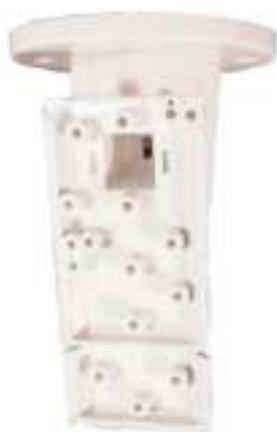
Шарнирный пластиковый потолочный кронштейн В338 устанавливается на поверхность потолка. Подходит для использования со многими типами извещателей. Угол поворота по вертикали от +7° до -16°; угол поворота по горизонтали ±45°.
